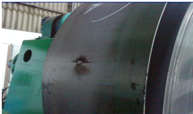
FIGURA 40.- Flejes con rebarba
