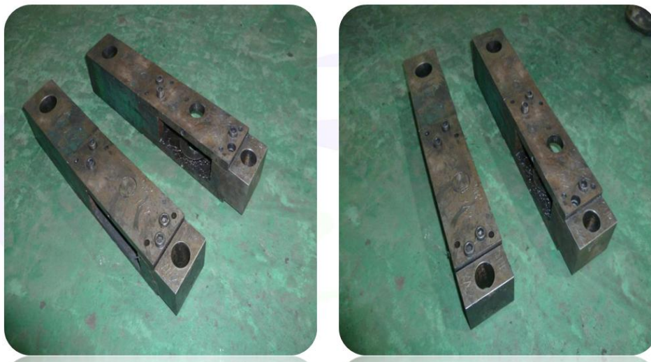
FIGURA 27.- Fabricación de Brazos de Refuerzos para Rodillos Formadores
