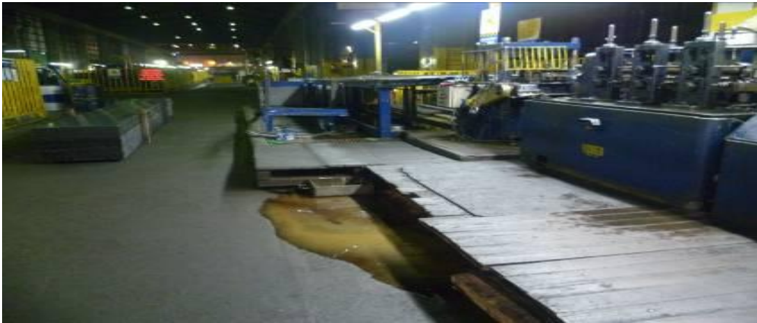
FIGURA 72. Derrame de refrigerante por pasadizos de las máquinas LAF lo cual genera una condición insegura para los colaboradores y pérdida de este líquido refrigerante causado por las fugas y derrames.
