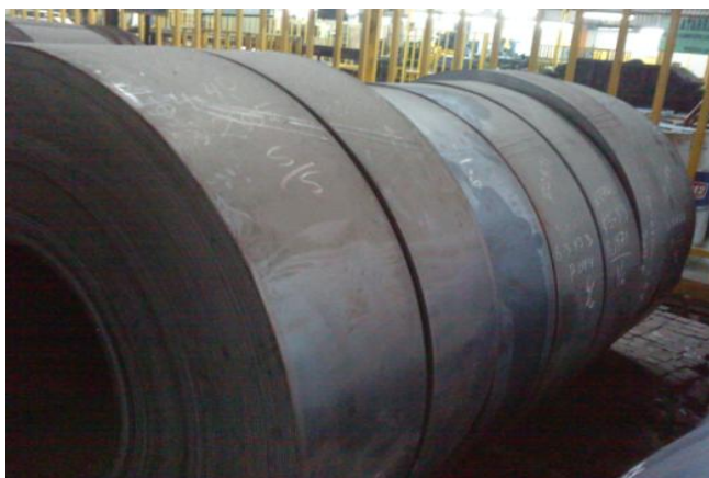
FIGURA 38.- Flejes con Oxidación
