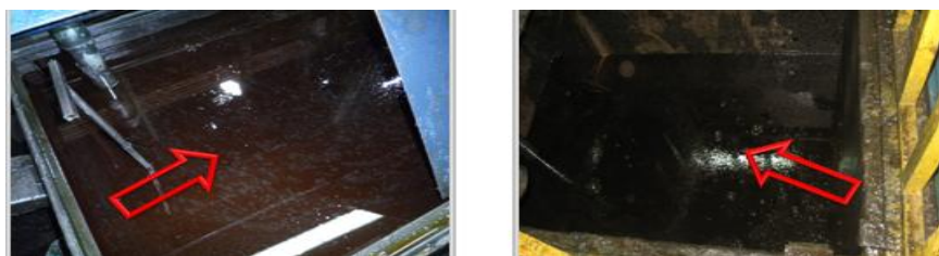
FIGURA 55.- Pozas de refrigeración mezcla de aceite Ferrocote con el refrigerante Qwerl
