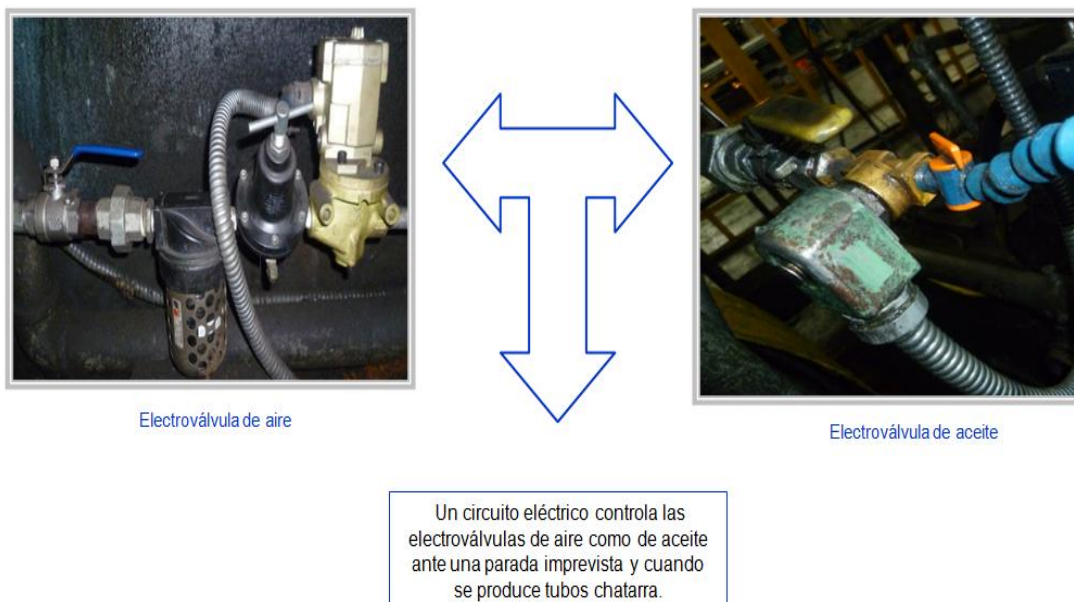
FIGURA 60.- Sincronización de aceite con la parada del sistema de soldado
