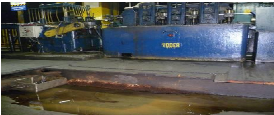
FIGURA 68.- Derrame de refrigerante en zona de trabajo.
