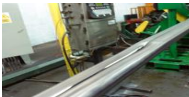
FIGURA 39.- Materia Prima con fallas en laminación
