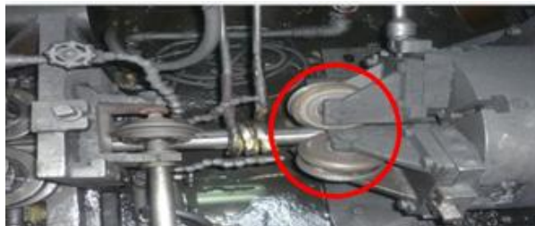
FIGURA 19.- Mal armado de cabeza de chuck por falta de grasa y ajustes de tuercas
