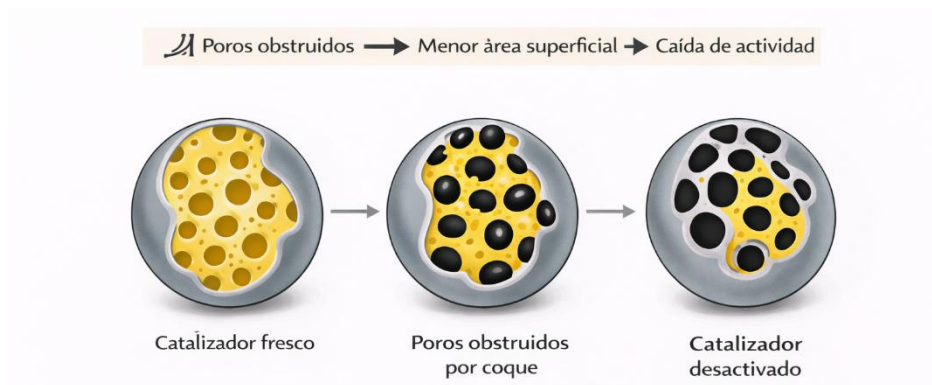
Figura 19 Desactivación por coque (descripción)
